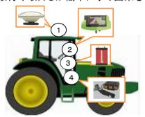
ステップ(1) マグネット付アンテナを置く ステップ② モニタをホルダーにセット ステップ③ レシーバーを接続して隅に置く ステップ④ シガー端子にソケットを差し込む (シガー端子がないときはバッテリー対応ケーブルを供給)
